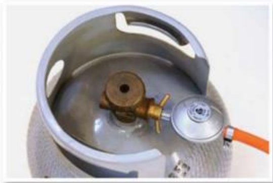
Kaasusäiliö ja siihen asennettu paineenalennusventtiili
